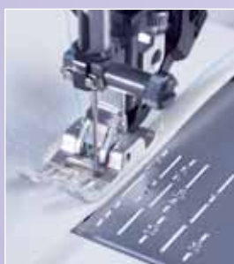
Mange nåleposisjoner! For nøyaktig toppstikning uten å måtte flytte stoffet. Perfekt til å sy i glidelåser.
